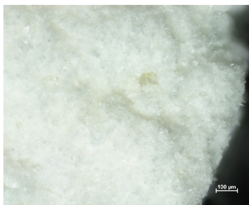
Figure 33 : Molda ® 3 Normal E/P = 0,95, MO x 10, échelle 100 µm.
