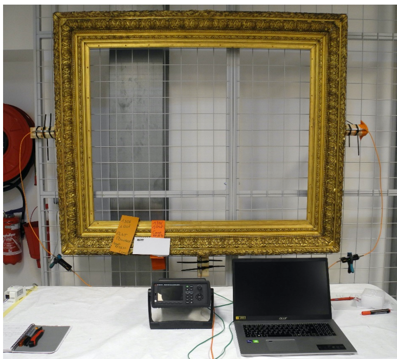
Figure 26 : espace et équipement du cadre ICMO 190 avec les trois capteurs de déplacement (n°8, n°7, et n°6, de gauche à droite), la centrale d'acquisition des données et la sonde thermocouple K pour relever la température à proximité de l'artefact © Musée du Louvre – J. Robin Dupire
