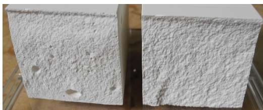
Figure 23 : éprouvette de plâtre Molda® 3 Normal, E/P = 0,45.
