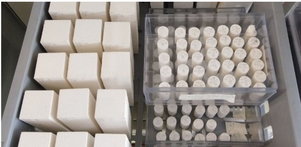
Figure 28 : détail des deux types d'éprouvettes prismatiques et cylindriques, après mise en œuvre et pendant le curage.
