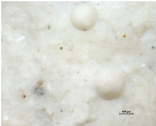
Figure 58 : craie, colle, et dioxyde de titane, MO x 10, échelle 100 \mu\text{m} .
