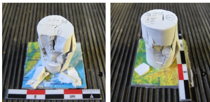
Figure 90 : éprouvettes cylindriques de craie de Bologne et colle animale (a) à 2 % de TiO 2 (b), après essai de compression.
