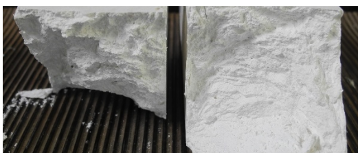
Figure 25 : éprouvette de plâtre Molda® 3 Normal, E/P = 0,9 et carbonate de calcium, ratio 1-1,5.
