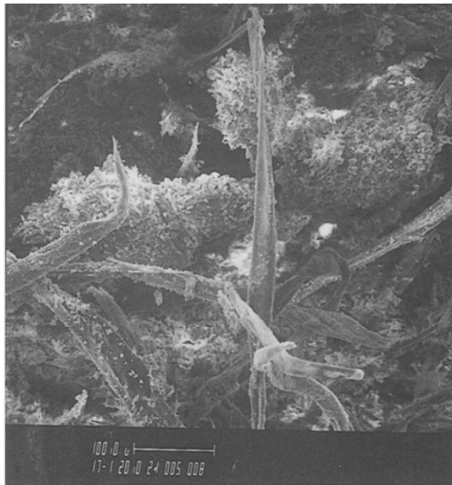
Figure 17 : plan de rupture d'une formulation de plâtre (E/P non renseigné) additionnée de fibres de cellulose, avec pressage imposé, MEB, échelle 100 μm (grandissement estimé x 200) ; tirée de Khenfer et Morlier, 1999.
