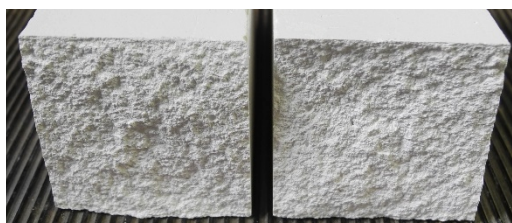
Figure 26 : éprouvette de plâtre Molda® 3 Normal, E/P = 1,5 ; carbonate de calcium, ratio 1-2 ; 2 % de dioxyde de titane.
