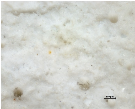
Figure 46 : craie et colle, MO x 10, échelle 100 µm.
