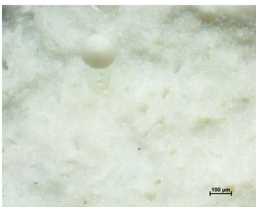
Figure 32 : Molda ® 3 Normal E/P = 0,45, MO x 10, échelle 100 µm.
