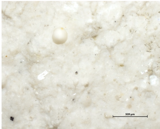
Figure 62 : craie, colle, et dioxyde de titane, MO x 5, échelle 500 μm.
